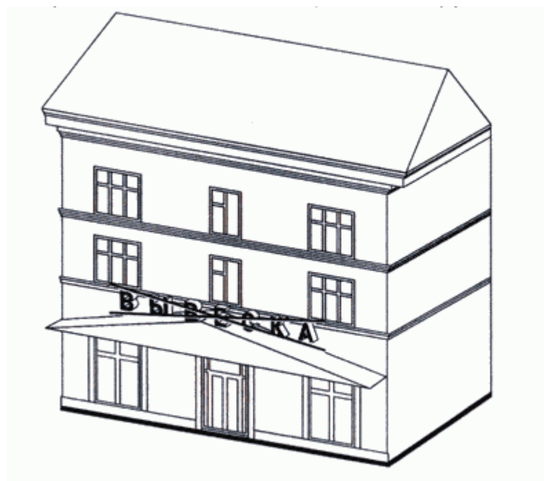
16.13. Запрещается перекрытие (закрытие) оконных и дверных проемов, а также витражей и витрин (пункты 10.1, 10.2 Правил).
